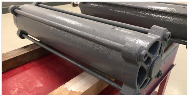
Coating met poly-urea van zware perslucht cylinders om deze bestand te maken tegen moeilijke omstandigheden
