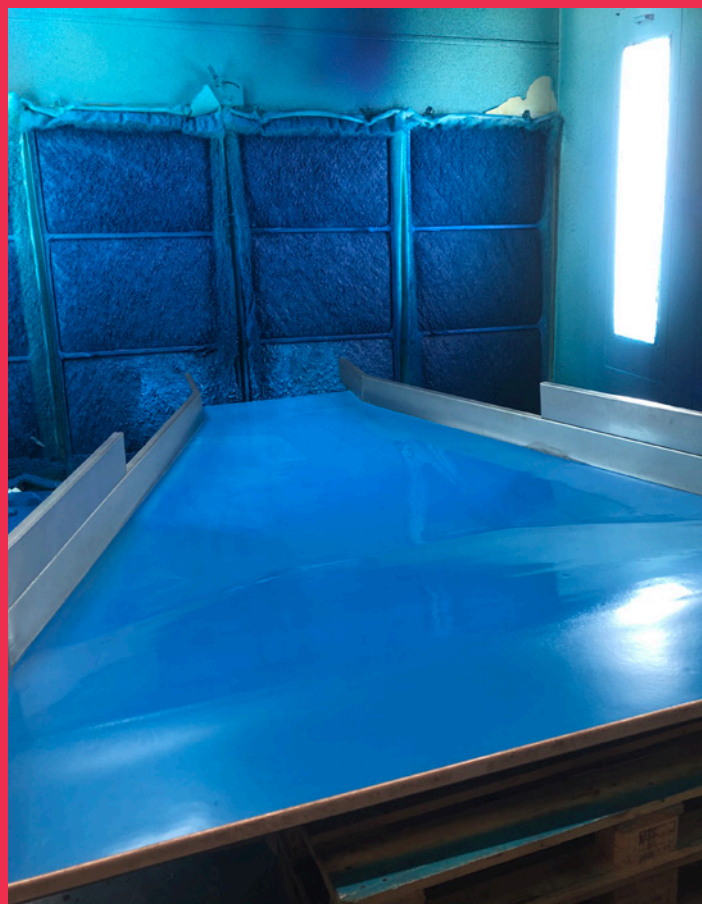
Schudgoot frietenfabriek bekleed met Narvithane PUR 85, EU voedingsgekeurd.
