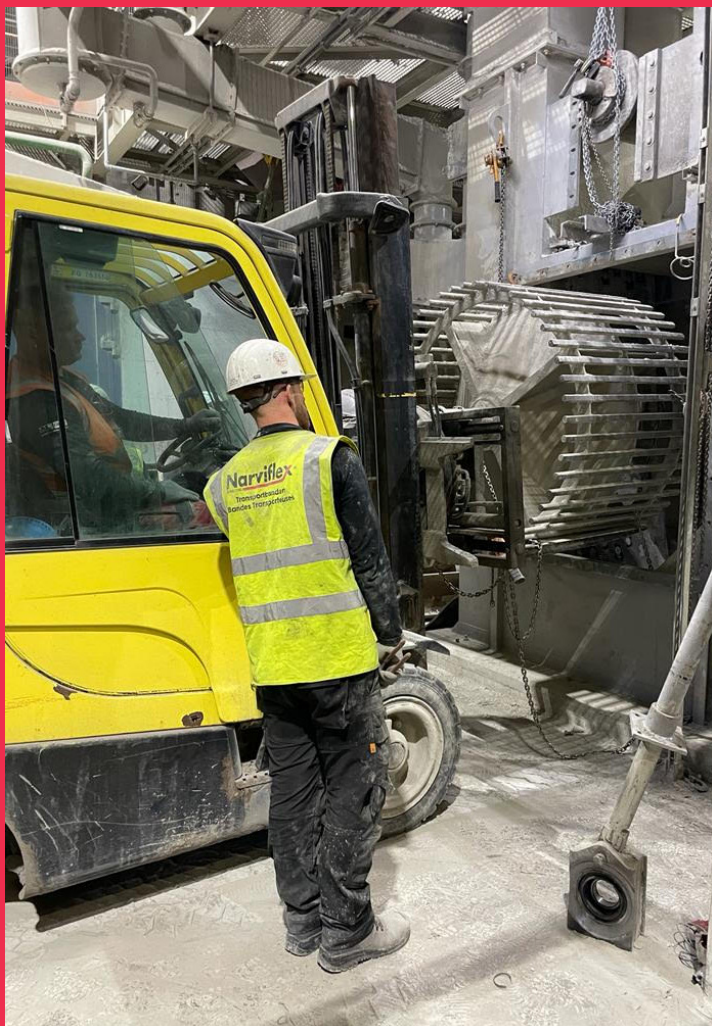
Rollen vervangen, trommels vervangen, afschrapers afstellen, etc.
