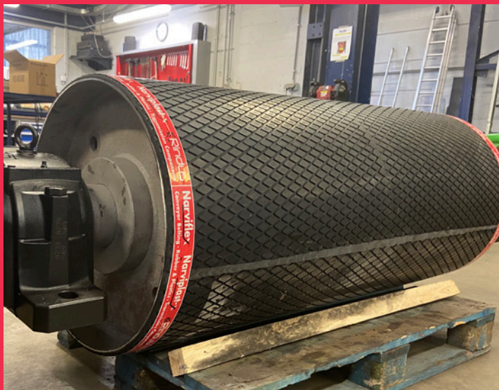
Bekleden van trommels met rubber, vlak of geruit, koud of warm ge vulcaniseerd. Tevens aanbrengen van keramiekbekledingen en keramiektegels.
