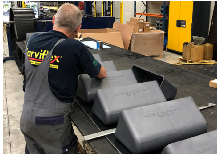
Narviflex / Rota Belting produceert, levert en monteert rubber en kunststof elevatorbanden. Wij kunnen deze ook voorgemonteerd met elevatorbekers erop, afleveren.
