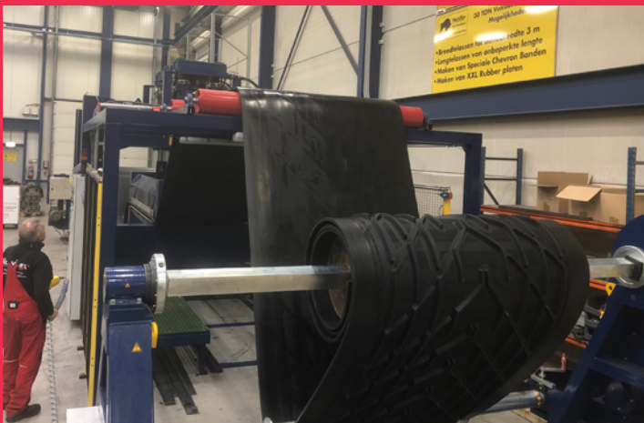
Dikke, sterke N-Flex band met VulcaBeast Chevrons
