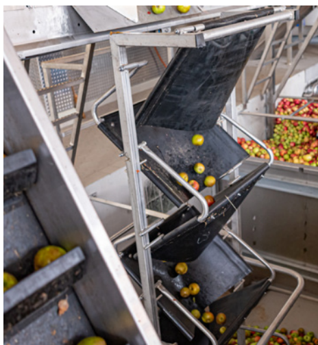
Waterjet gesneden rubber valbrekerdoeken.
