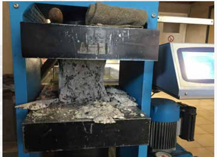
Controle van de druksterkte van het beton.
