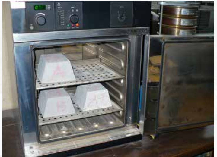
Meting van de waterabsorptie van het beton.
